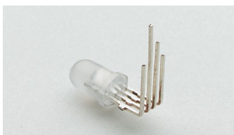
13 5 mm, 90° Biegung/5 mm, 90° bending
