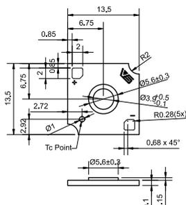
Die Luft- und Kriechstrecken der Module sind für den Betrieb an SELV-Treibern ausgelegt. Alternativ zur Befestigung mittels LED-Halter können die Comfort COBs mit Schrauben befestigt werden. Dann müssen die Leitungen an den Löt pads angelötet werden.
